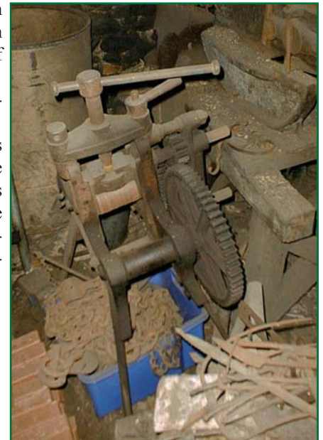
Radbiegevorrichtung aus der alten Schmiede in Gadernheim, die seit 1631 besteht und seither immer im Familienbesitz war.
